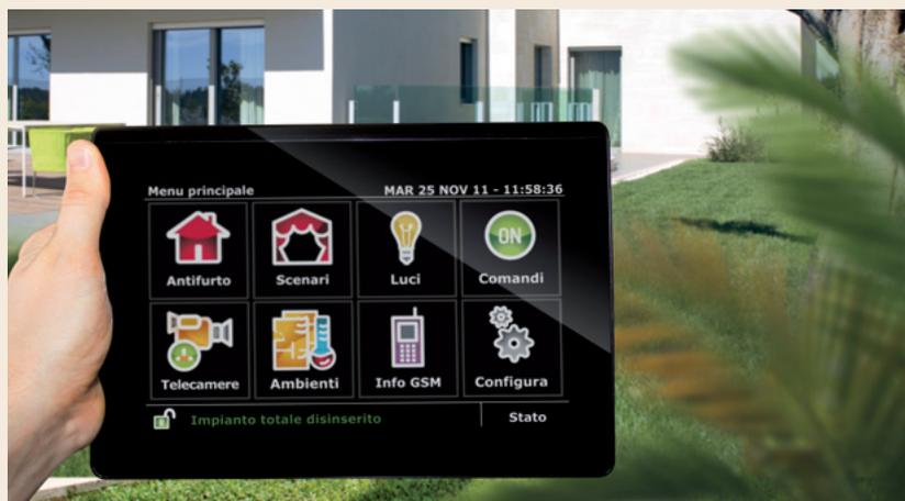
collegarsi alla centrale, in locale tramite LAN o Wlan e a distanza tramite ADSL, e di scaricare le pagine di gestione in modo da eseguire le funzioni antifurto, domotiche e video (inserimenti, attivazione comandi, regolazione clima e visualizzazione delle telecamere) senza obbligo di applicativi dedicati.
